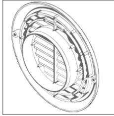
4. Luego de colocar el adaptador, la rejilla esta pronta para ser instalada en la pared, con el set de instalación que trae incluido (tornillos, tacos fisher y tapa tornillos).
